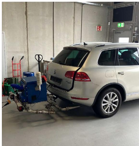
**Abbildung 11: VW Touareg mit aufgerüstetem PEMS-Gerät**
