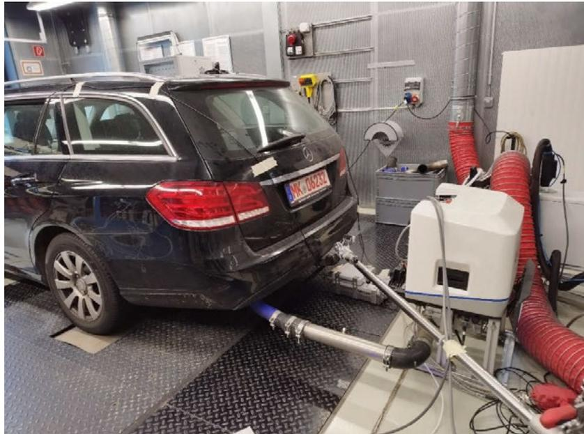
**Abbildung 10: Mercedes Benz E220 CDI auf dem Rollenprüfstand**
