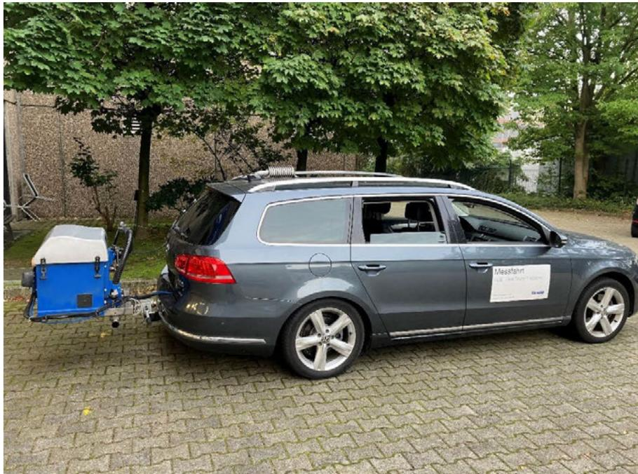
**Abbildung 9: VW Passat mit aufgerüstetem PEMS-Gerät**
