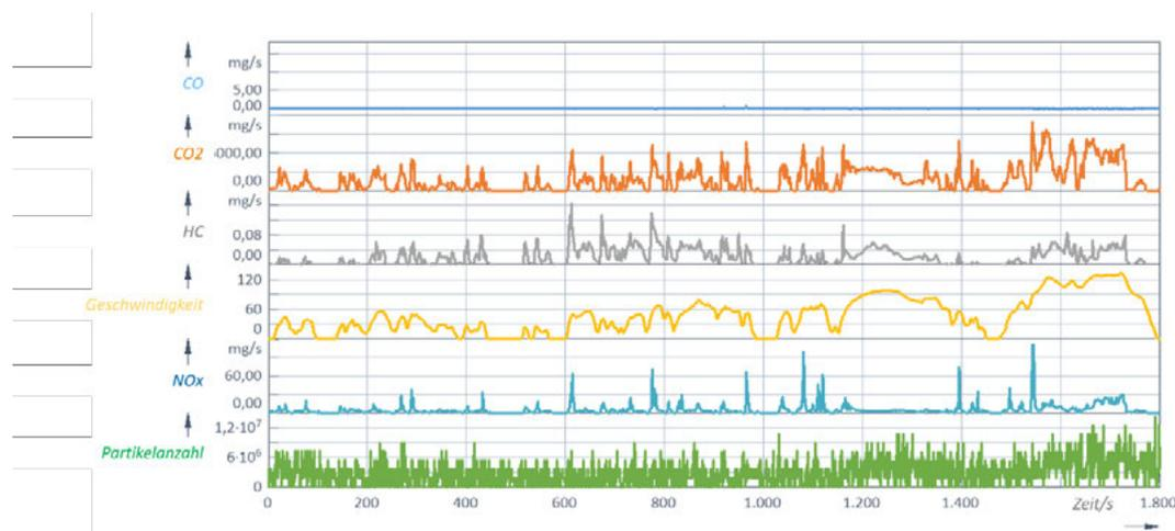
**Abbildung 16: Auszug der Datenaufzeichnung eines WLTC**
