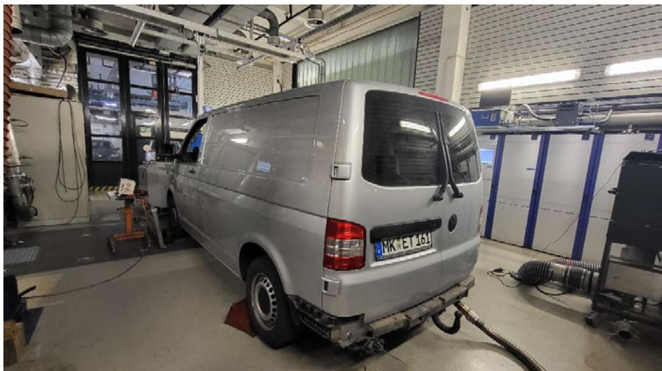
**Abbildung 12: VW T5 auf dem Rollenprüfstand**
