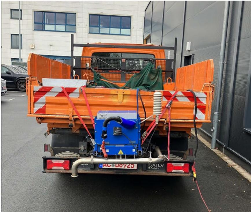
**Abbildung 14: Iveco Daily mit aufgerüstetem PEMS-Gerät**
