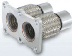
Flexrohr mit Flansch VAG · HJS-Nr. 83 00 8300 Flex pipe with Flange VAG Maße | Dimensions: Di 47,0 mm · L-ges | total L. 130,0 mm
