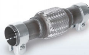
Flexrohr Opel/universal · HJS-Nr. 83 00 8412 Flex pipe Opel/universal Maße | Dimensions: Di E 42,5 mm · Di A 45,5 mm · L-ges | total L. 244,0 mm
