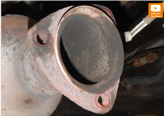
Abbildung zeigt Flanschverbindung am Volvo 740 Picture shows flange connection from a Volvo 740
