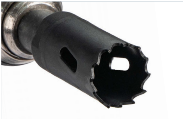
3. Ausnahmslos Ø 25 mm Lochsäge ohne Zentrierbohrer verwenden
