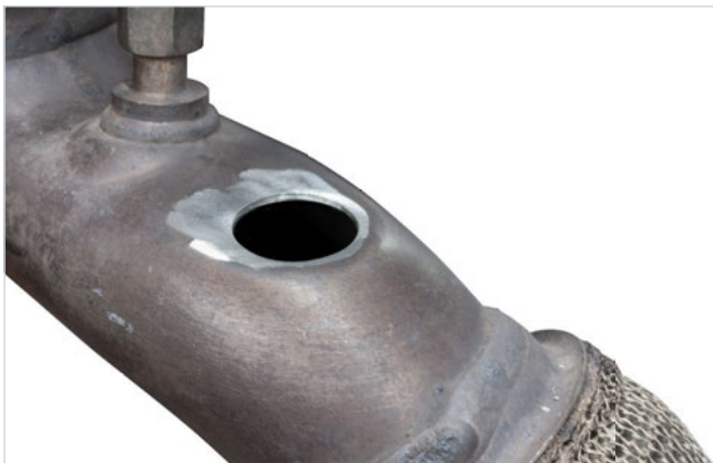
5. Bohrung entgraten. Bohrspäne sorgfältig entfernen.
