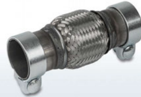
Flexrohr universal · HJS-Nr. 83 00 8405 Flex pipe universal Maße | Dimensions: Di 60,5 mm · L-ges | total L. 210,0 mm
