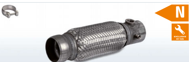
Reparaturrohr MB · HJS-Nr. 91 13 1568 Repair pipe MB Maße | Dimensions: Di A 63,5 mm · L-ges | total L. 310,0 mm
