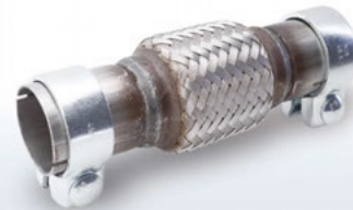
Flexrohr Seat/VW/universal · HJS-Nr. 83 00 8409 Flex pipe Seat/VW/universal Maße | Dimensions: Di 45,5 mm · L-ges | total L. 210,0 mm
